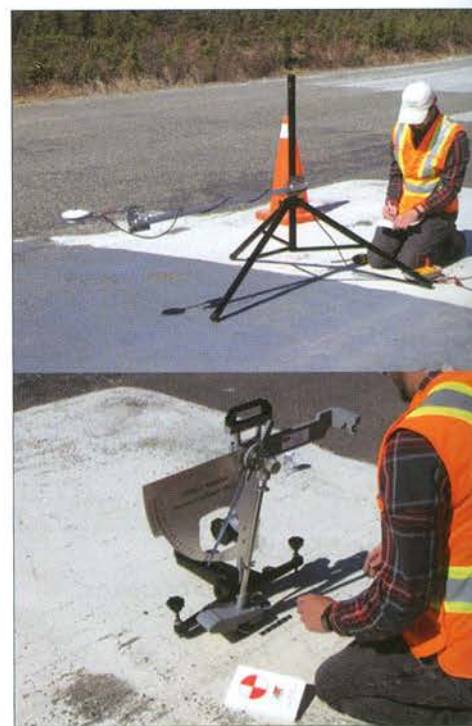
Figure 2 : Mesure de l'albédo (haut) et de la glissance (bas), Beaver Creek, Yukon, mai 2013
