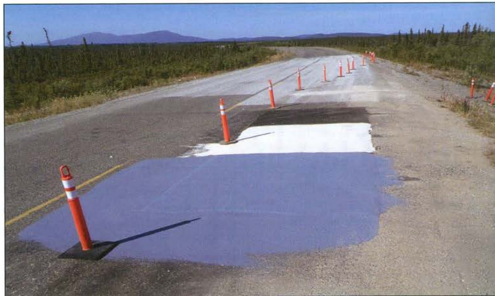
Figure 1 : Site expérimental de Beaver Creek. Du bas vers le haut: Nippo, Lafrentz, enrobé de correction à froid et traitement de surface à granulats clairs
