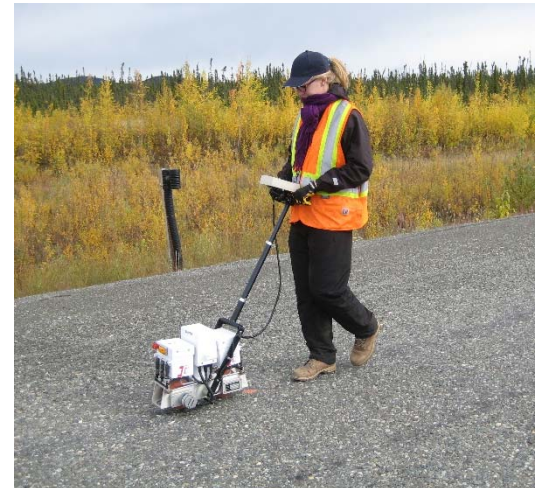
Surpro, profilomètre à basse vitesse, Alaska Highway, Yukon
