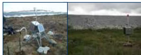
Stations d'acquisition de données thermiques sur le pergélisol à l'aéroport de Tasiujaq
